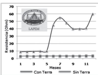
Las gráficas muestran las curvas de resistencia entre un cable con y sin TERRA.
