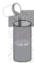
**4** En cepas donde se guía el cable desnudo (malla ó anillo de tierras), aplicar una capa de 5 cm de intensificador TERRA, antes de tender el cable y otra capa de 5 cm de intensificador TERRA después detender el cable.
