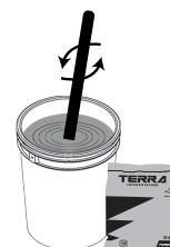
**3** Proceda a vaciar la mezcla del TERRA que preparó, rodeando el electrodo desde el fondo de la perforación hasta que el nivel del TERRA cubra por lo menos la mitad del electrodo.
